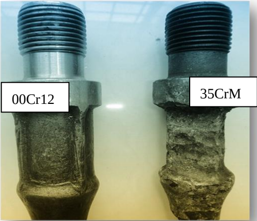
图 3-3 激光处理后新材料与传统材料在大港油田使用 100 天情况对比
